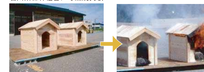
左側: Kitt防炎剤含浸木材 右側: 普通の木材 左側: 一部炭化しているが発火はせず 右側: 全焼状態
